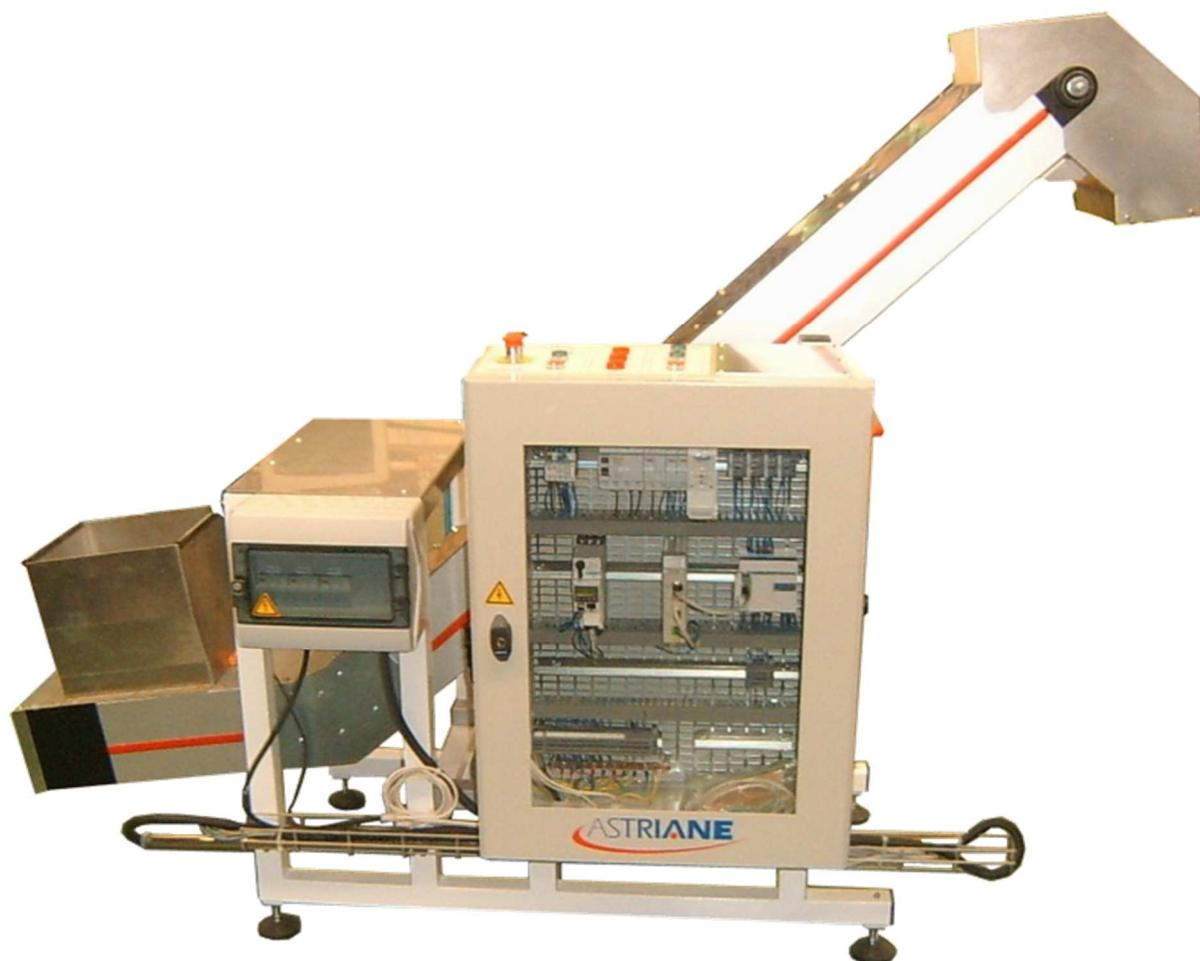
**Ce convoyeur à bande incliné met en relation le broyeur birotor et le compacteur hydraulique de la ligne de recyclage RECYCLICC.**
